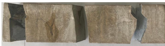
Рисунок 4.34 – Разрушение образца 4x4x16 см с кварцевым наполнителем в воде при 80 °С
