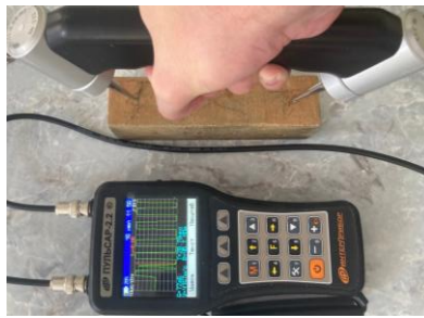
Рисунок 4.3 – Ультразвуковая диагностика образца мелкозернистого бетона через 12 мес твердения в воде при 80 °С
